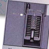
ZIF socket for fast out-of-circuit tests
