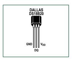
Figure 1. DS18B20 appearance and pinout.
