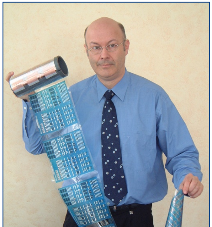
Bild 4. Elektronik von der Rolle - hier demonstriert durch Dr. Karl-Heinz Bock von der Fraunhofer-Gesellschaft (Bild: Knapp).
