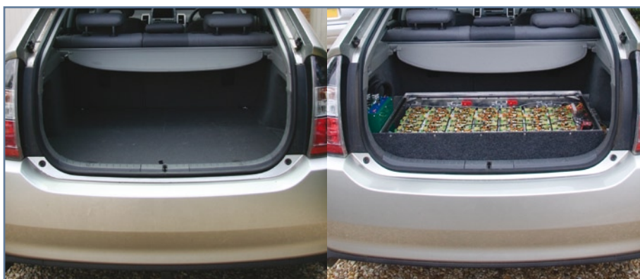
Bild 5. Vor (5a) und nach (5b) der Umrüstung auf das neue Batterie-System.
