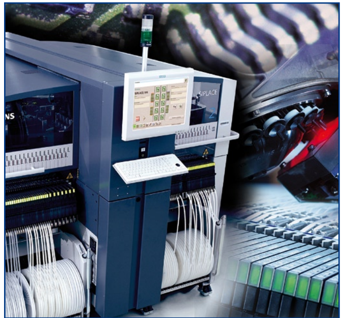
Bild 3. Der neue Bestückungsautomat Siplace X4i dürfte derzeit einen Weltrekord an montierten Bauteilen pro Stunde aufstellen. Leider haben noch nicht alle Hersteller auf die neue Bewertungsnorm umgestellt, was Vergleiche erschwerte (Bild: Siemens).
