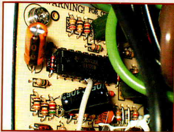
7. Es ist oft gar nicht so einfach, den Schutz gegen Überlastung zu finden – siehe Text. In unserem Fall muss Pin 4 von LM339 oberhalb 1,1 V bleiben, sonst schlägt die Stromversorgung Alarm.
