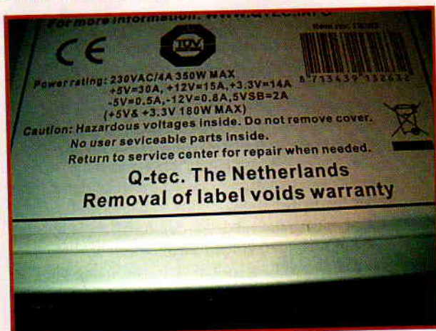
2. Satte 15 A an 12 V bedeuten 180 W für unsere Halogenbeleuchtung.
