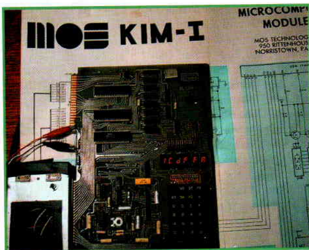
Bild 1. Der KIM-1 von MOS Technology. Zur Eingabe diente ein hexadezimalles Tastenfeld, für die Ausgabe war ein sechsstelliges LED-Sieben-segment-Display vorhanden.
