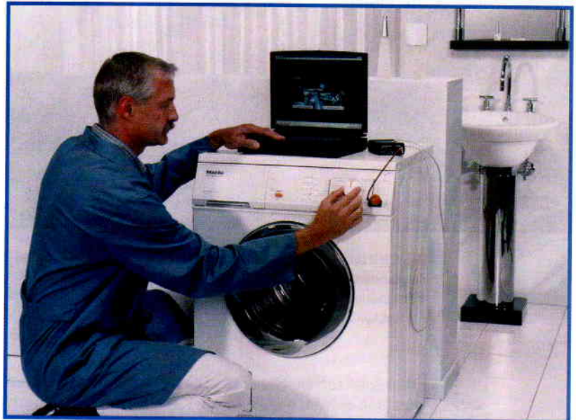
Bild 1. Über die optische Schnittstelle der Waschmaschine (hier vom Saugnapf des Interfaces verdeckt) lassen sich neue Programmparameter einspielen – so zum Beispiel, wenn effizientere Waschmittel auf den Markt kommen.
