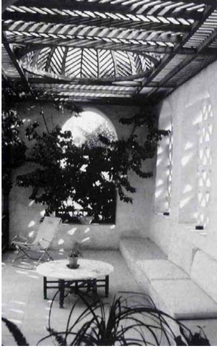
منزل عقيل سامي - شبرامنت - القاهرة هنا يظهر اهتمام فتحي بتوفير الظلال والتهوية حيث يمر الهواء الى التختيش من خلال الفتحات الموجودة في الحائط .
